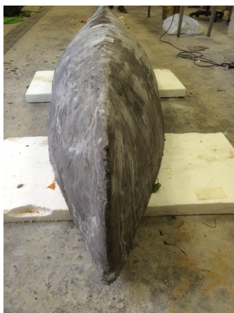
③モルタル施工
