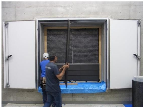
（写真2：遮音性能実験の様子）
