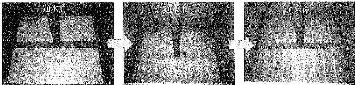
図6 通水によるろ布の変化状況
