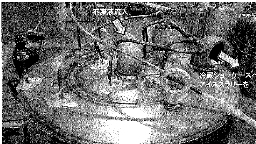
写真1 密閉型アイスラリー製氷器 製作状況 (上部溶接)
